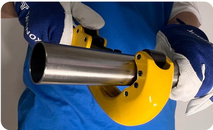
Abgeschnittene Rohrenden müssen sauber, kratzfrei und frei von scharfen Kanten sein. Das Rohr sorgfältig von Spänen und Verschmutzungen reinigen, um eine Beschädigung des O-Rings beim Einführen des Rohres in das Fitting zu verhindern.
